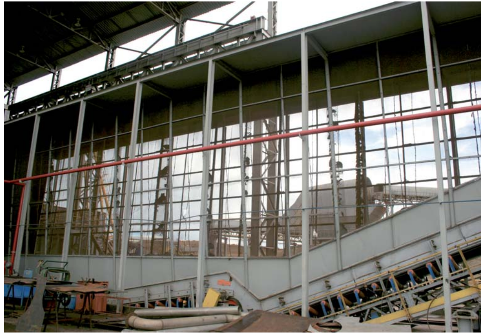
Na Equipav, mesa de limpeza a seco e a tela que segura as palhas arremessadas pelo ventilador
