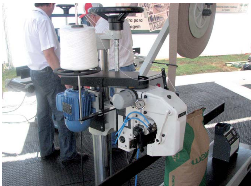
Cabeçote de costura modelo CW-130D da Waig Industrial: sistema blindado que impossibilita a entrada de sujeiras
