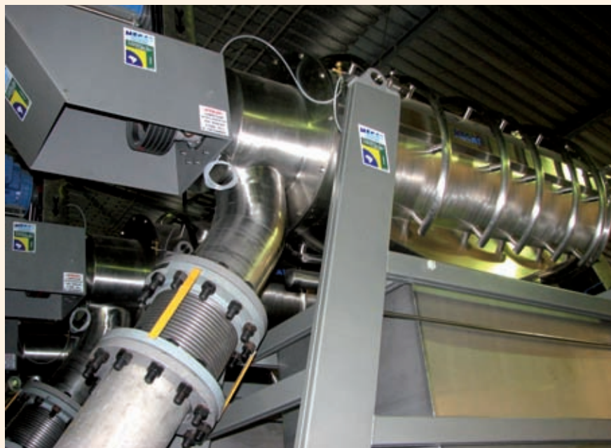
Turbo Filtro da Mecat retém 98% dos sólidos insolúveis do caldo clarificado
