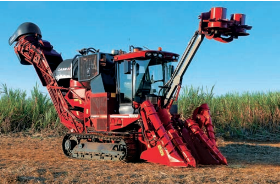
Os modelos A8000 e A8800 possuem transmissão e direção eletrônica por joystick, que possibilita o menor esforço e maior facilidade para operar a colhedora
